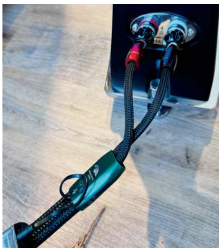
Lautsprecherterminal im Ständer integriert
