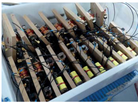
Andere, vorgefertigte Frequenzweichen bereit zum Einbau
