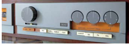
Vorverstärker Quad 33, erster Transistorvorverstärker von Quad
