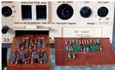
Quad 33 mit den steckbaren Anpassplatinen
