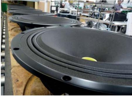
Fertige High End Chassis nach der „Hochzeit“
