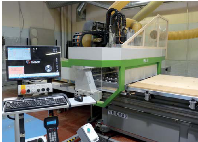
Bearbeitungsautomaten für die Lautsprechergehäuse, CNC gesteuert.
