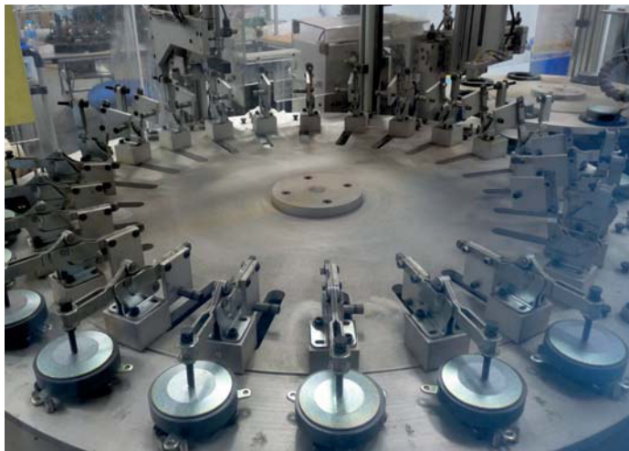
Selbst die unterschiedlichen Magnete werden hier im eigenen Unternehmen gefertigt und auch magnetisiert
