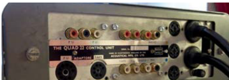
Die Anschlussseite des 22er
