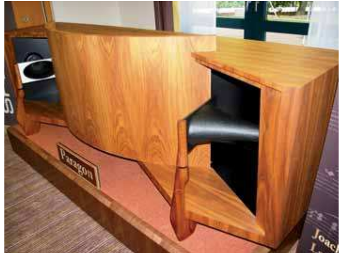
Hornlegende „JBL Paragon“ (2,75 m breit) mit Originalchassis aus dem Jahr 1957 in der Vorführung bei „Sperling Audio“ (Raum „Vision“), Gehäuse erneuert durch „Joachim Nagel Gehäusebau“
