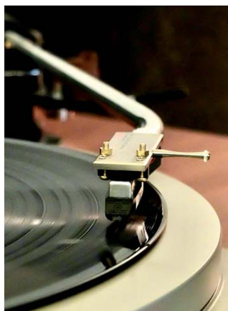
*Teampayer:* Durch seine harte Aufhängung passt das ADC »QLM 30 MK« III zu mittelschweren bis sehr schweren Tonarmen. Hier spielt es an einem 12" Schick Tonarm zusammen mit einem Headshell der Firma YAMAMOTO. Das Headshell kostet dreimal so viel wie das Tonabnehmer-System. Trotzdem halte ich das ADC für einen würdigen Partner dieses Headshells. Das »QLM 30 Mk III« kann weitaus mehr, als der Kaufpreis vermuten lässt.
