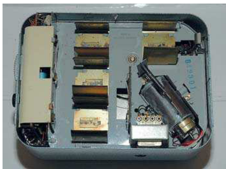
Innenansicht von unten: Elektronikplatine (senkrecht, links), Batteriekasten, und diagonal eingebauter DISTLER-Motor
