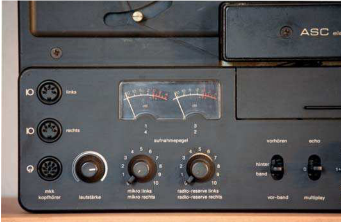
Aussteuerungsinstrumente und Regler der AS 5004. Die Zeigerinstrumente sind nur während der Aufnahme beleuchtet und aktiv!
