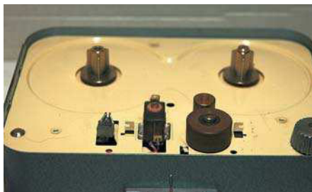
Bandlaufelemente und Tonköpfe des PHONOTRIX
