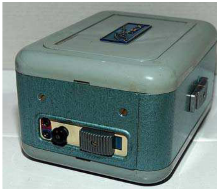
Linke Seite: Anschlüsse für Mikro und Lautsprecher, Lautstärke- bzw. Aussteuerungsregler, Umschalter für Wiedergabe- und Aufnahmemodus
