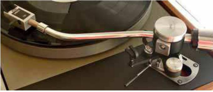
*Nachgerüsteter Acoustic Solid-Tonarm mit THORENS/EMT MCH II-Tondose »van den Hul« (Laufwerk von Hans-Dieter Metternich aus Koblenz).*
