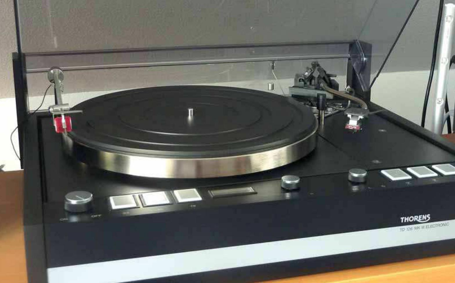
*Laufwerk mit allen Finessen der 1980er Jahre: Der TD 126 Mk III mit Tonarm SME 3009/III*
