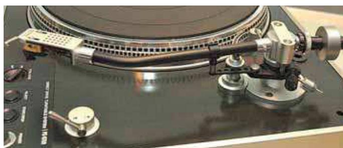
Hochpräziser Tonarm des Sony PS-8750: Ein PUA-1600S mit Carbonrohr
