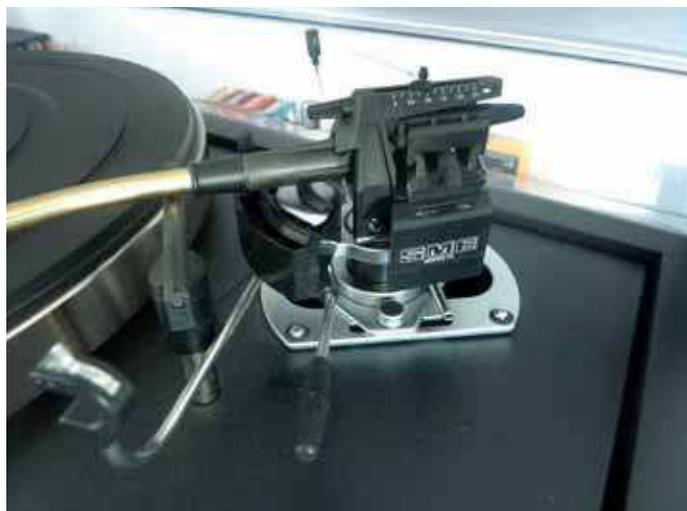
Die mit Silikonöl befüllte Dämpferwanne optimiert die Klangeigenschaften der Tonarm-/System-Einheit.
