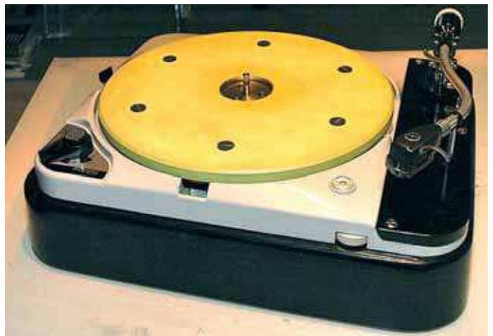
*Raffiniert: Der schwere Laufsteller konnte sekundenschnell vom Subteller entkoppelt und wieder aufgesetzt werden.*
