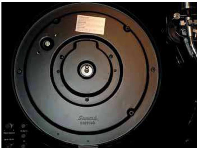
*Aus Alu-Druckguss: Gehäuse der Antriebseinheit des Sansui SR-929*
