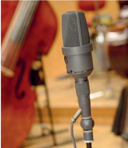
„Das darf auch mal »fett« klingen“: Stützmikrofon NEUMANN TLM 170 für den Kontrabass.
